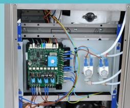
Le dispositif d'autosantisation intégré est géré par une électronique complète du pilotage du cycle de stérilisation.
